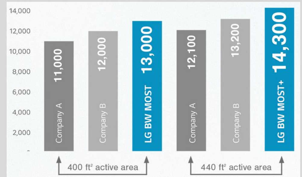
Graph A: Comparativo de Flujo de Permeado (GPD) Condiciones de Testeo: 500 ppm NaCl, 100 psi feed pressure, 15% recovery, pH 7
