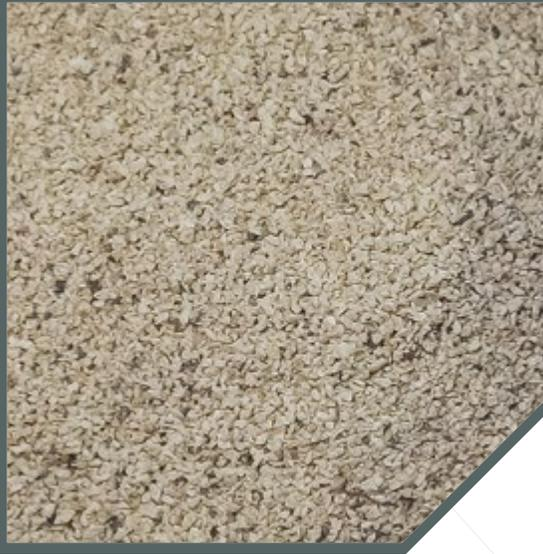
La zeolita natural es un mineral con propiedades únicas. Su estabilidad y micro porosidad la hacen el medio de filtración perfecto para prácticamente cualquier aplicación en la industria de la purificación de agua y tratamiento de aguas residuales.
