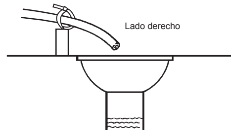
Figura 12 Conexión de la tubería de desagüe
